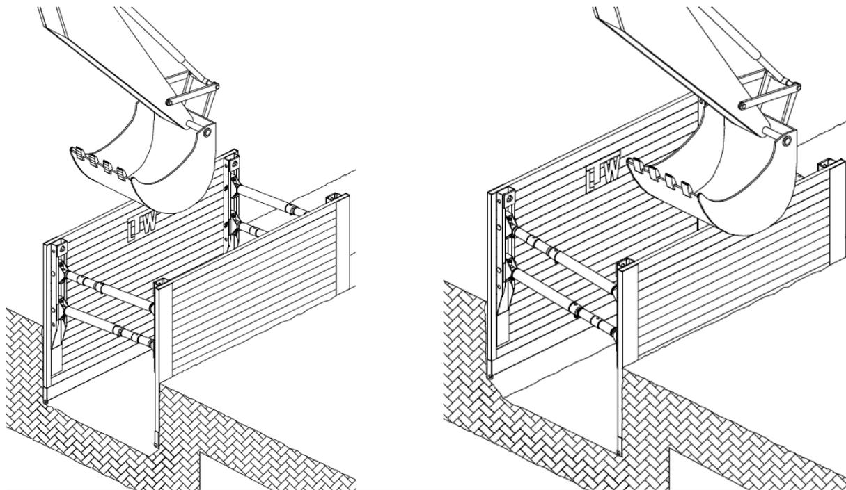
При нестабилни почви модулът се поставя чрез последователно натискане на основните панели (потъване). За предпазване на панелите се препоръчва използване на протектори.
